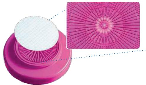
El soporte de drenaje asegura la forma de la membrana para un perfecto contacto con el medio y una recuperación óptima de los microorganismos.
