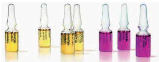
Ampolla color amarillo después de 48 horas de incubación: Proceso de esterilización inadecuado.
